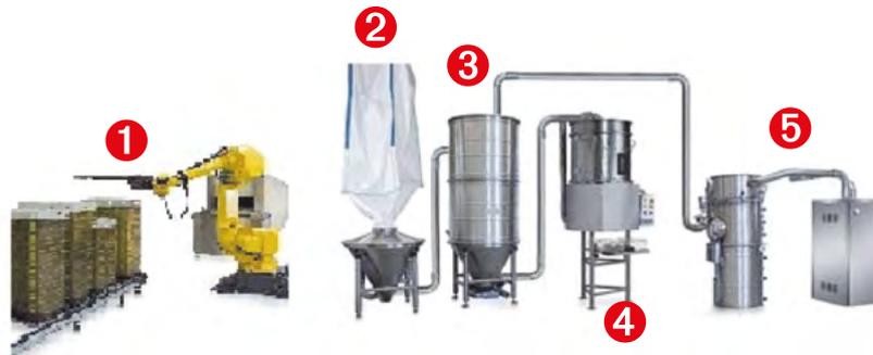
Abb. 4-19 Beispiel eines vollautomatischen Systems: Befüllung der Käfige mit Roboter oder Automaten ①, Befülltrichter saubere Einstreu z. B. mit BIG-Bag ②, optionales Lagersilo ③, Dosierspeicher mit Staubabsaugeinrichtung ④ und Vakuumerzeuger und Staubfilter ⑤ für die pneumatische Förderung.
