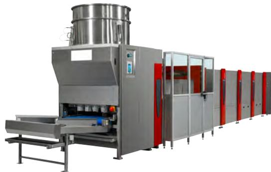
Abb. 4-18 Beispiel eines vollautomatischen Systems: Einstreubefüllung von automatisch gewendeten Käfigschalen nach der Reinigung in einer Käfigbandreinigungsanlage
