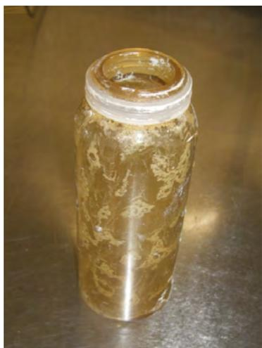
Abb. 7-7 Tränkeflasche mit Prüfanschmutzung
