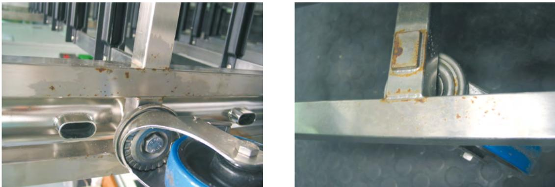
Abb. 9-7 Ansicht Edelstahlgestelle mit Korrosion
