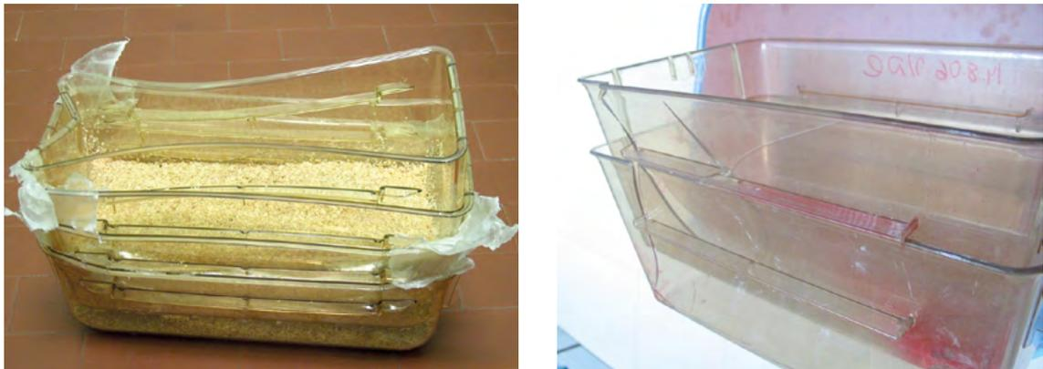
Abb. 9-6 links Verformung bei Käfigschalen, rechts Risse bei Käfigschalen
