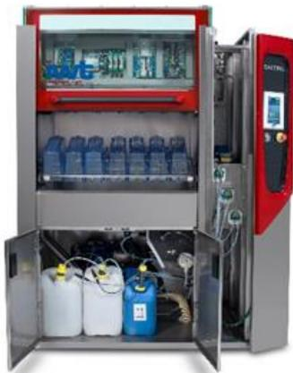
Zum Betrieb der Anlage ist nur die Strom- und Wasserversorgung am Aufstellort sicherzustellen. Ebenso benötigt die Anlage keine Anbindung an die bauseitige Abluftanlage.
