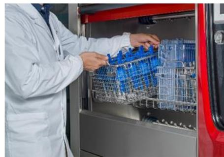
Die integrierten Waschgutträger nehmen alle Aquarienbestandteile auf und sorgen für eine gezielte, effektive Beaufschlagung während des Reinigungsprozesses.
