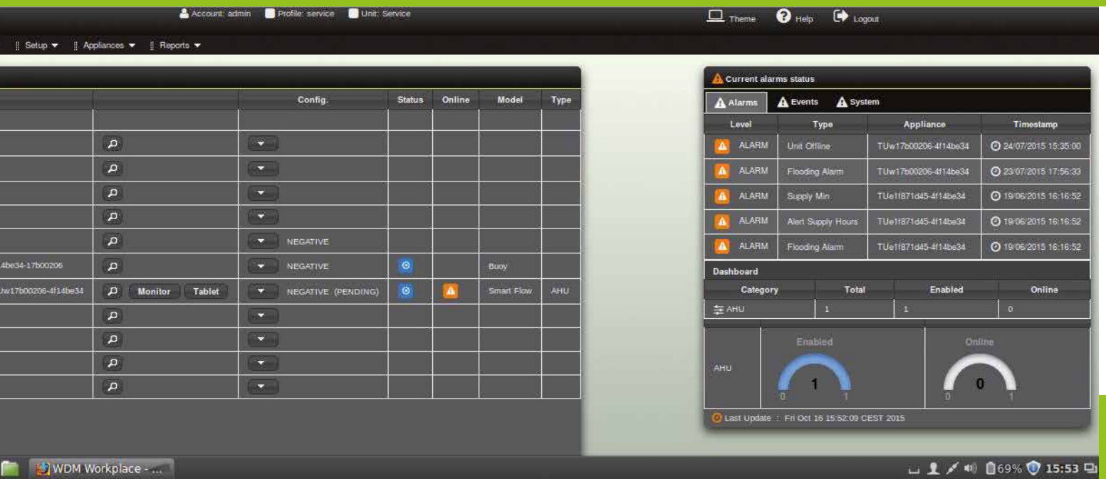
PAGE D'ACCUEIL DE GUARDIAN: PERMET LA CONFIGURATION DU SYSTÈME QUI S'APPLIQUERA AUX UNITÉS DE VENTILATION DANS UNE PIÈCE OU UN ÉTAGE
